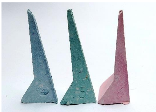
ILUSTRACIÓN 15. CONOS PIROMÉTRICOS 4, 5 Y 6 ANTES DE HORNEAR (IZQ.)
