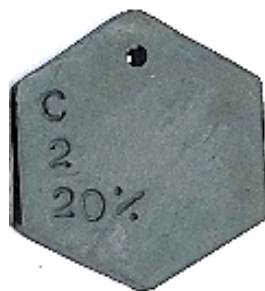
ILUSTRACIÓN 14. EJEMPLO DE UNA MUESTRA DE PASTA MARCA CRECER COLOR BLANCO CON AGREGADO DE 20% DE PIGMENTO NÚMERO 2 GRIS PIZARRA
