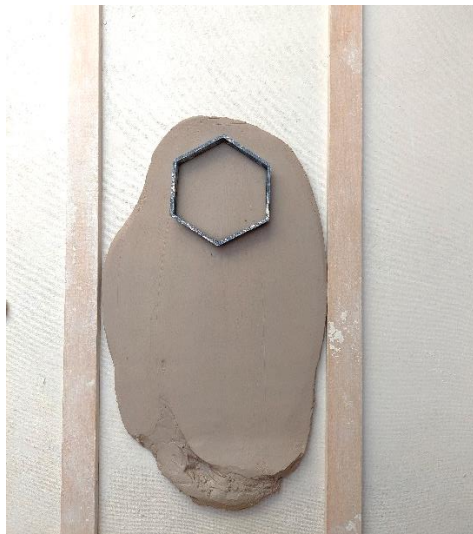
ILUSTRACIÓN 12. ESTIRADO DE LA PASTA Y CORTADO DE LA FORMA POR MEDIO DE CORTANTE
