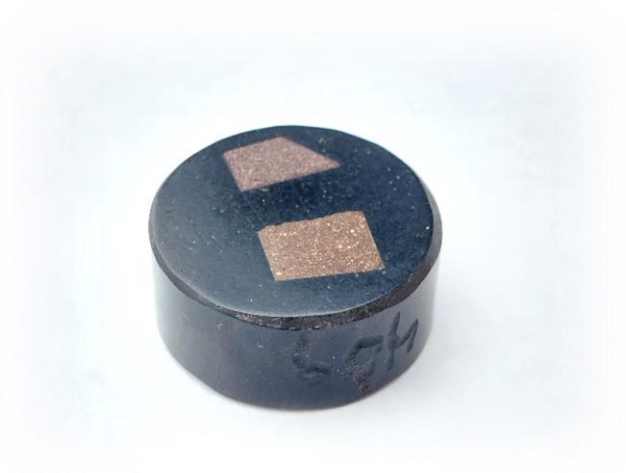
ILUSTRACIÓN 23. PREPARACIÓN DE AMBAS MUESTRAS COLOCADAS EN RESINA
