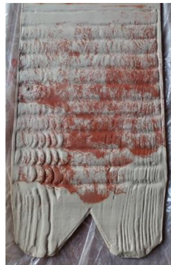
Fig. 5: plancha prensada s/molde de tabla de lavar
