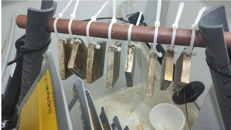
Fotografía N°9: las probetas suspendidas en el equipo de la niebla
