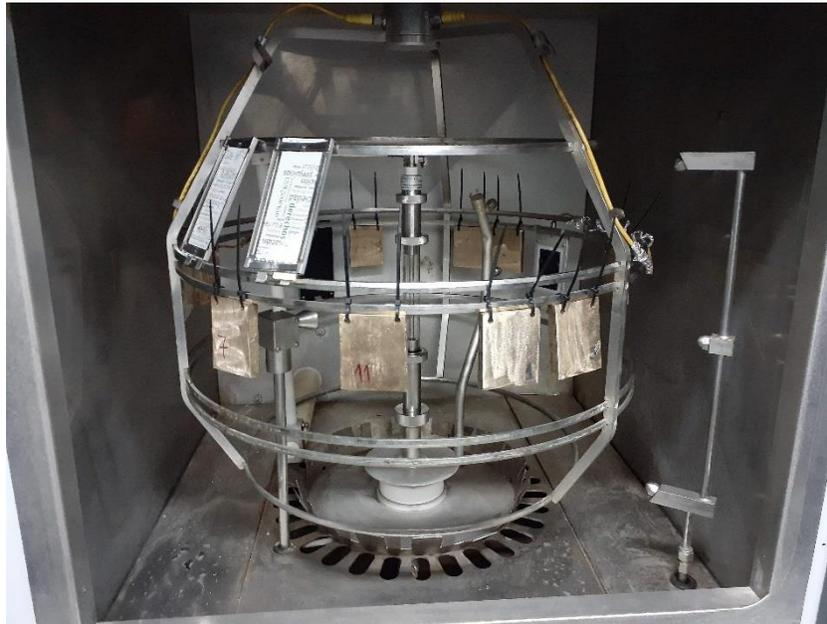
Fotografía N°8: Las probetas suspendidas en el WOM.
