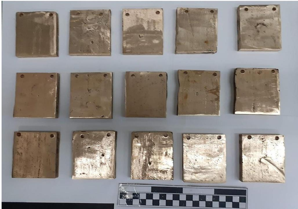
Fotografía N°4: Probetas de bronce sin recubrimientos.
