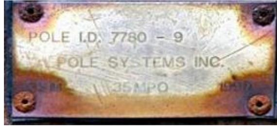
**Imagen N°1:** Placa corroída por corrosión galvánica.
