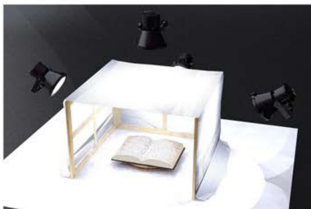
Diseño del módulo de iluminación que forma parte del dispositivo estativo diseñado en el marco del Proyecto PICTTA 34/0689, para la digitalización 3D de fondos librarios antiguos.
